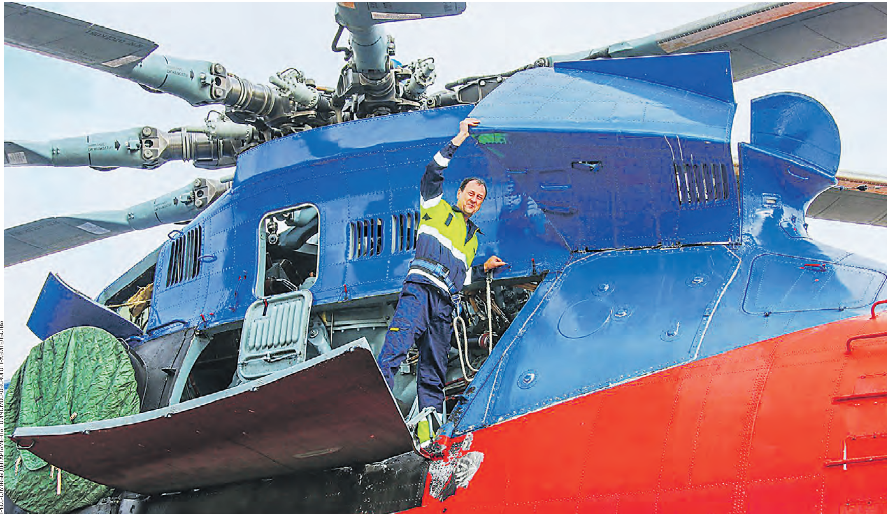
22 октября. Авиационный техник по планеру и двигателям цеха ТО ВС Сергей Курьянович проводит обслуживание вертолета Ми-26Т. В зимнее время предполетная подготовка машины будет включать дополнительные операции по защите от наледи и коррозии
