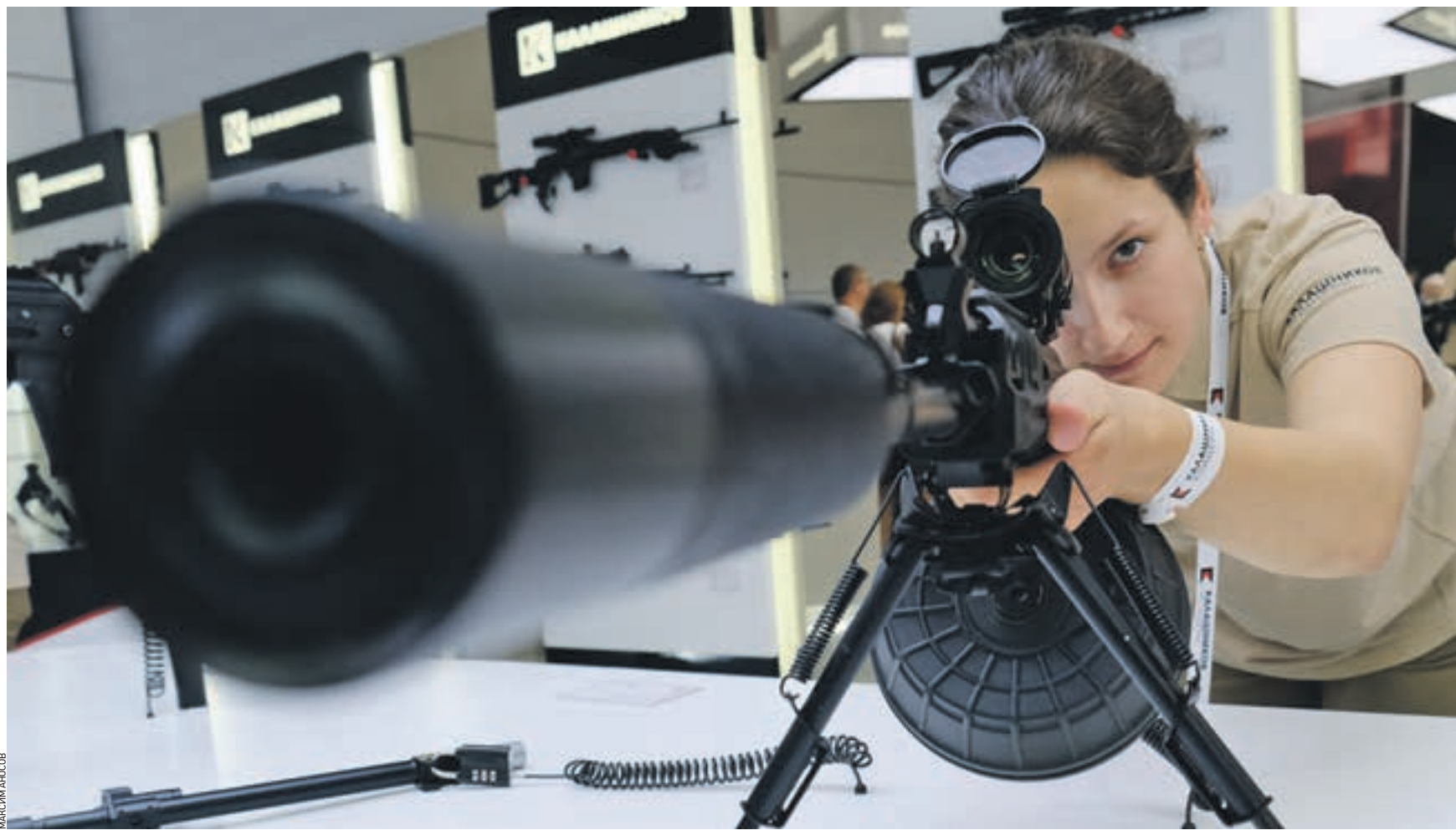
Вчера 12:21 Инженер-конструктор концерна «Калашников» Анастасия Серебrenникова демонстрирует модернизированный ручной пулемет с дисковым магазином, оптическим прицелом и прибором для бесшумной стрельбы (ПБС)
