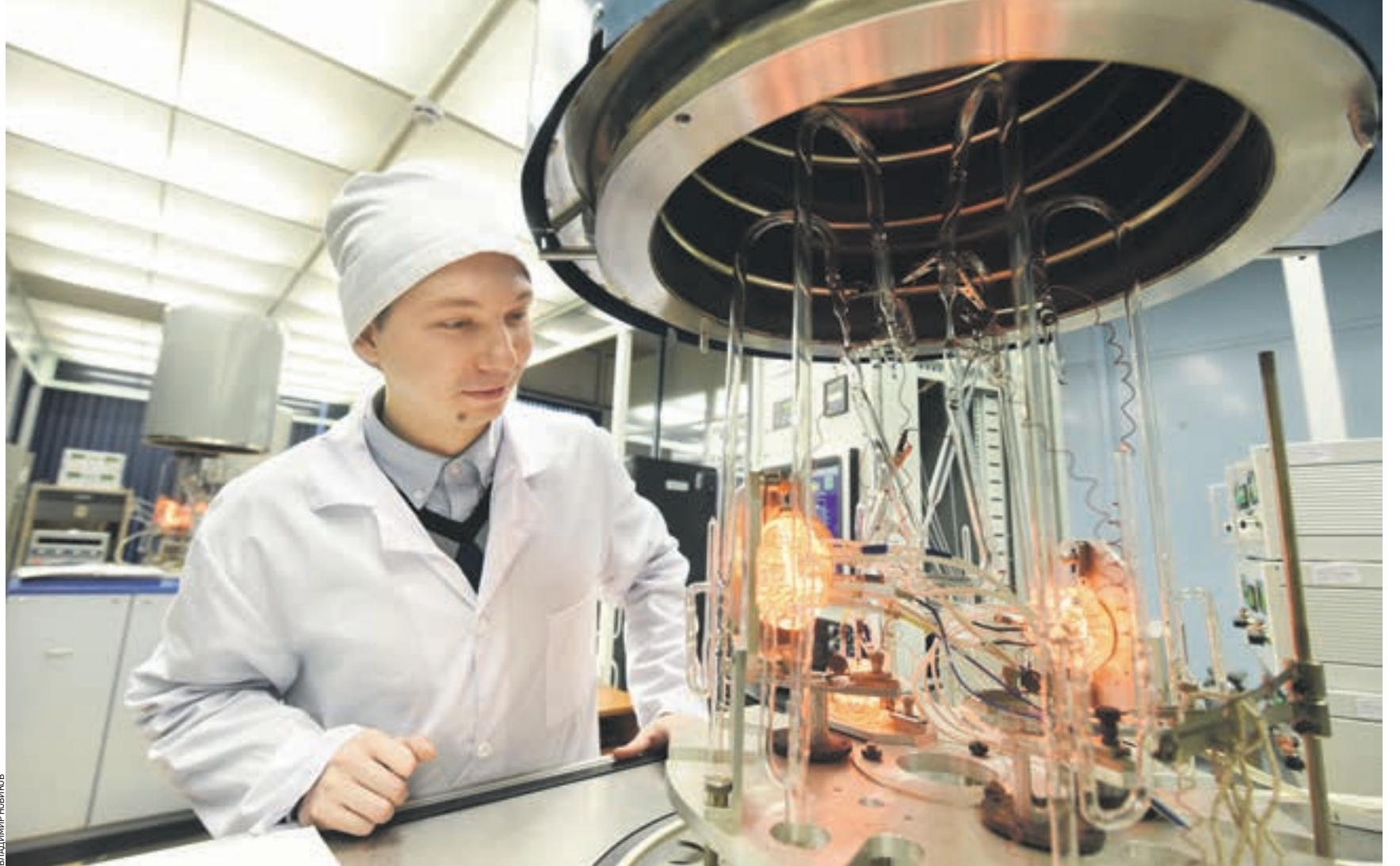
27 октября 2016 года. Начальник участка термовакuumной обработки научно-исследовательского института «Полус» имени Стельмаха (Технопарк «Полус») Владимир Котов готовит к работе лазерный гироскоп — аппарат, который отслеживает скорость движения и положение в пространстве абсолютно любых объектов. Создание благоприятных условий для развития бизнеса, в том числе технополисов, — одна из задач Штаба по защите бизнеса
