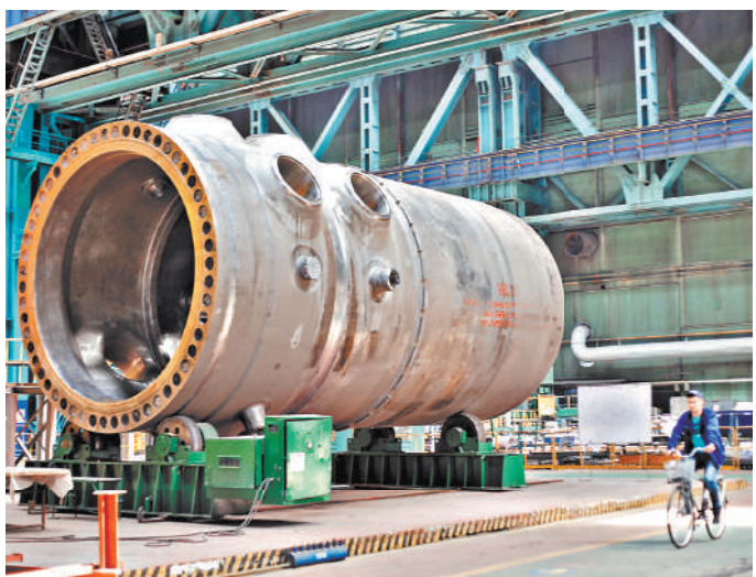
Контроль за поставками в России ядерных материалов и оборудования такой же строгий, как и контроль за качеством изготовления 300-тонных корпусов реактора на волгодонском «Атоммаше».
