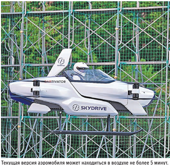
Текущая версия аэромобиль может находиться в воздухе не более 5 минут.
