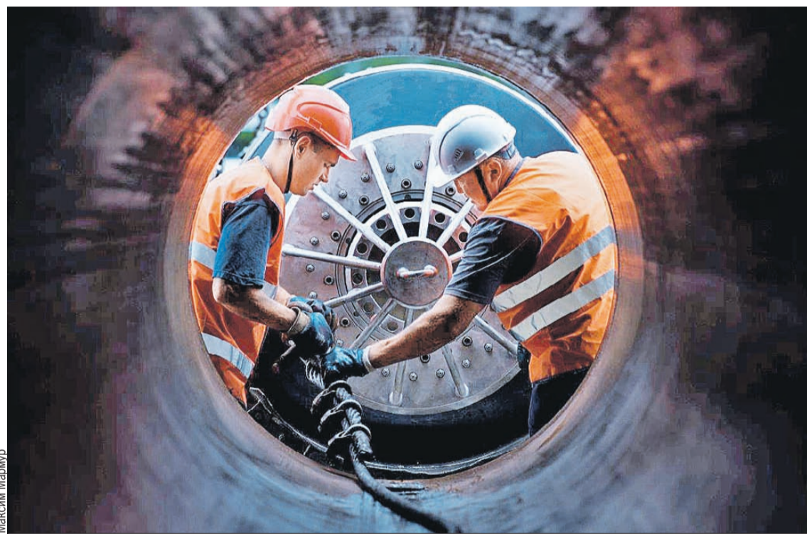
Специалисты АО «Транснефть-Диаскан» осуществляют диагностику трубопроводов с помощью внутритрубных инспекционных приборов собственного производства, которые по своим параметрам находятся на уровне лучших мировых образцов, а некоторые не имеют аналогов в мире.
