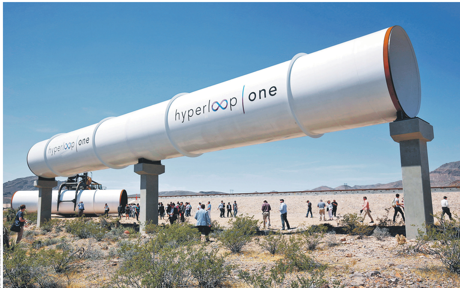
На испытании в июле этого года поезд Hyperloop разогнался до 310 км/ч в 500-метровой трубе. Проектная скорость поезда — 1200 км/ч
