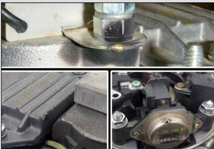
Рисунок 1: Следы подгорания в местах подключения (сверху) и на регуляторе (слева и справа) в результате короткого замыкания.
