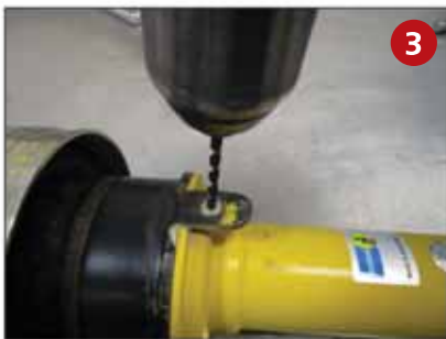
Удалите заклепку со стойки амортизатора.
