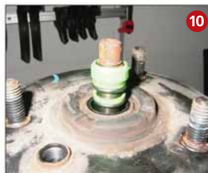
Расположите пневмопружину на амортизаторе и установите оставшиеся уплотняющие кольца на штоке амортизатора. Установите верхний упорный диск.
