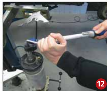
Прикрутите пневмопружину к амортизатору. Создайте давление в пневмопружине и зафиксируйте заклепку.
