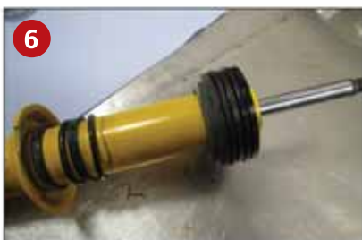
Демонтируйте оставшиеся уплотняющие кольца.
