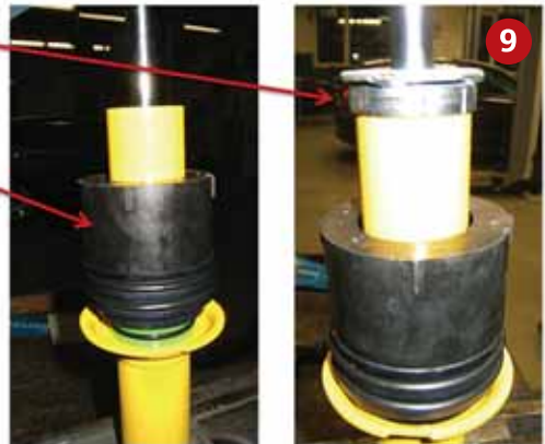
Установите металлический колпак после монтажа компонента А.
