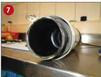
Необходимо очистить поверхность пневмопружины и удостовериться в отсутствии повреждений.
