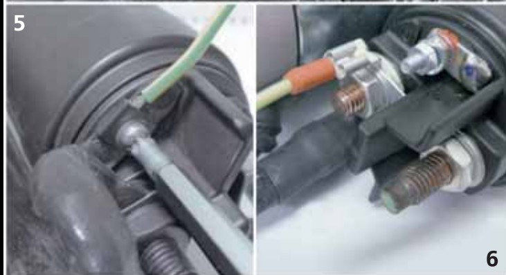
5. Кабель, подключенный к клемме 50, соответствующей электромагнитному реле.
