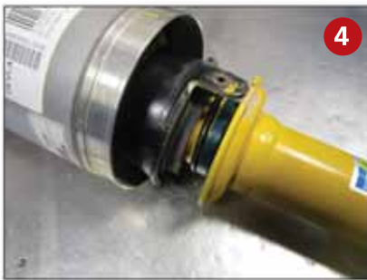
Демонтируйте пневмопружину с амортизатора. Проверьте правильность расположения уплотняющих колец.
