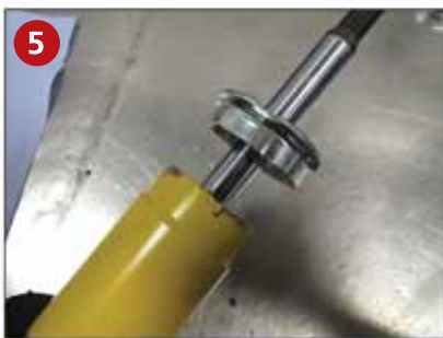
Демонтируйте отбойник амортизатора, а также металлический колпак (упор для отбойника).
